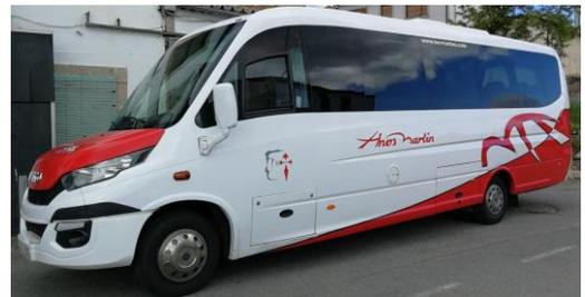
**DIMENSIONES.** Altura: 2.920 mm. / Anchura: 2.160 mm. / Longitud: 7.720 mm. / N° Plazas: 25 ó 28 / Volumen de bodega: 2.20 m<sup>3</sup>.
